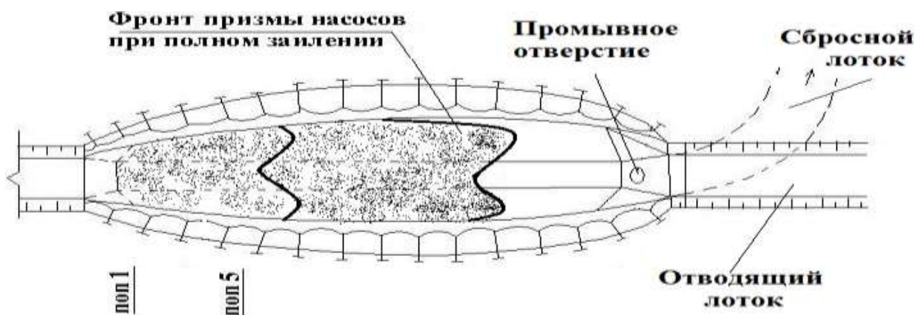
Рисунок 3. Схема плановой формы заиления камеры мягкого ирригационного отстойника
